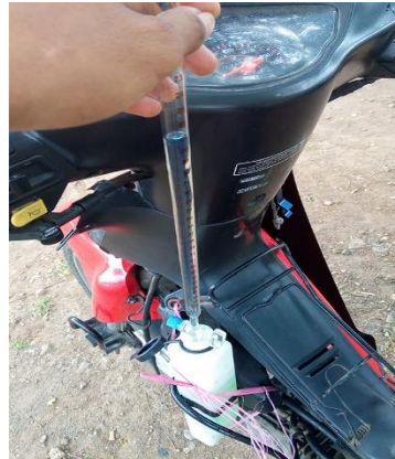
Gambar 3.68 Pengukuran suhu oli Gambar 3.69 Pengukuran KBB
