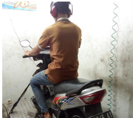
Gambar 3.60 Posisi pengukuran torsi dan daya
