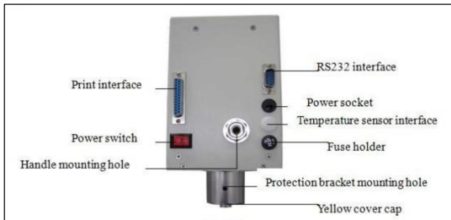
Gambar 3.23 Bagian kepala viskometer (Sumber : Manual book)
