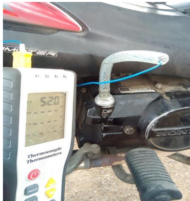
Gambar 3.68 Pengukuran suhu oli Gambar 3.69 Pengukuran KBB
