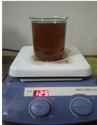
Gambar 3.27 Posisi dudukan memakai hot plate stirrer
