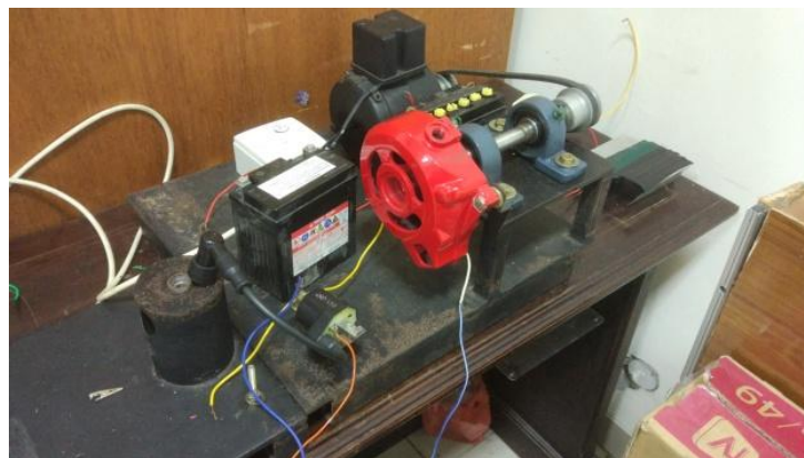
Gambar 3.11 Alat percikan bunga api pada busi
