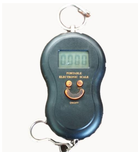
Gambar 3.14. Timbangan digital gantung
