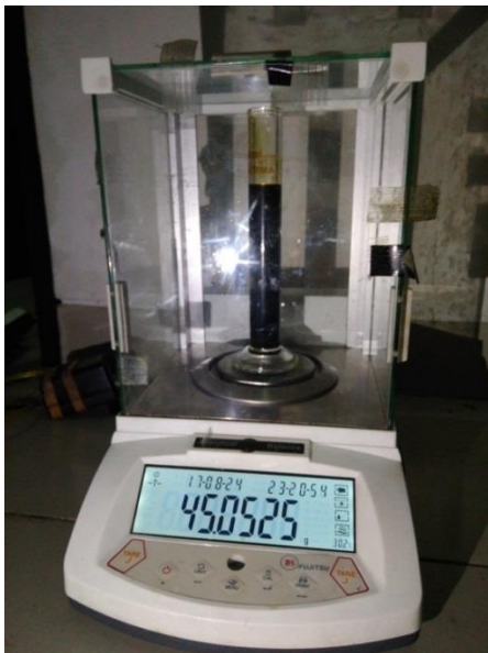
b. Uji Densitas minyak limbah ban (0.90105 gr/ml)
