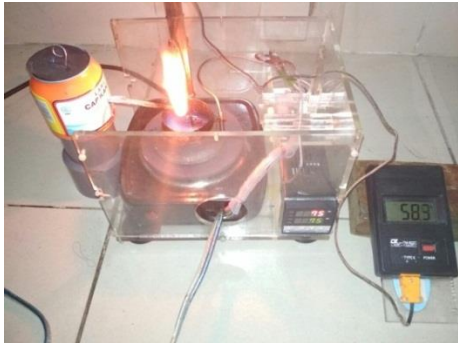
a. Uji flash point minyak limbah ban (58-60 °C)
