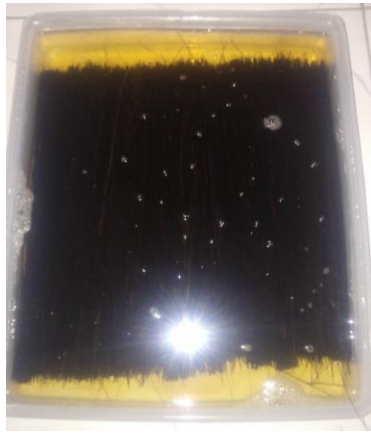
Gambar 3.11. Ijuk aren direndam dalam larutan alkali
