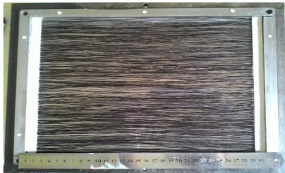
Gambar 3.12. Ijuk aren yang sudah tersusun di cetakan
