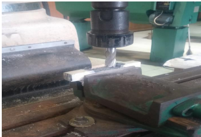
Gambar 3.18. Proses pembentukan spesimen uji tarik sesuai ASTM D638
