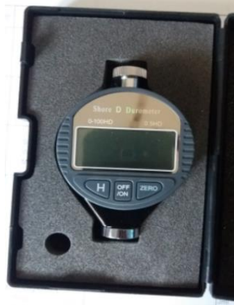
Gambar 3.11 Alat Uji Kekerasan Durometer
