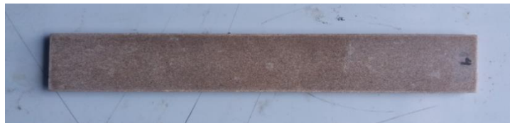
Gambar 3.18 Spesimen Kampas Rem
