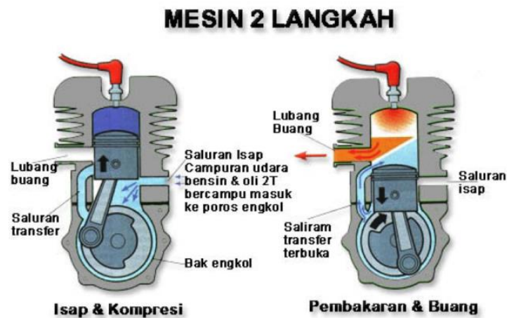
Gambar 2.7 Siklus kerja engine 2 tak/2 langkah (Takarina, 2014)
