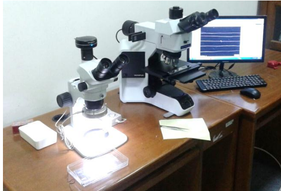
Gambar 2.7. Mikroskop optik OLYMPUS-SZ61TR
