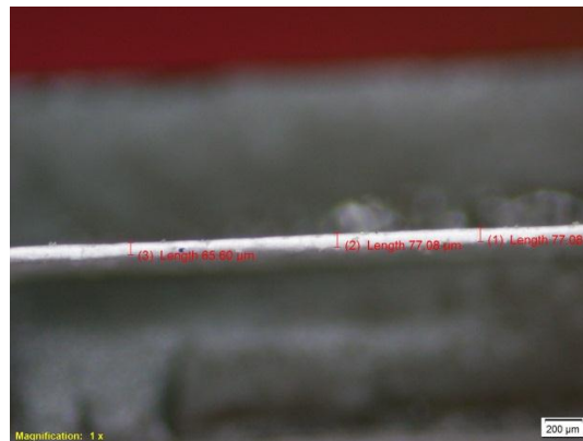
Gambar 3.29. Proses pengukuran ketebalan menggunakan skala pada OM
