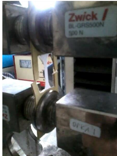
Gambar 3.30. Proses uji tarik
