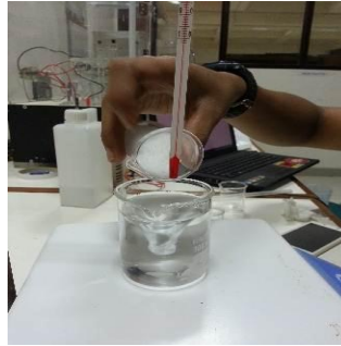
Gambar 3.21 Proses pelarutan PVA ke dalam aquades
