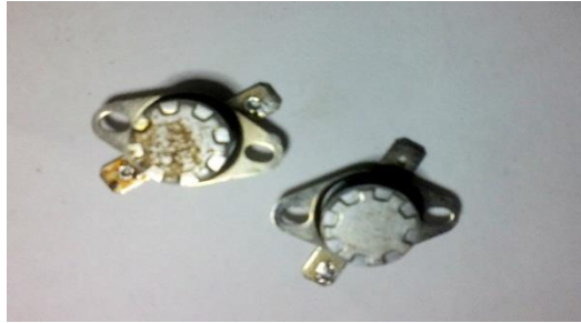
Gambar 3.8 Thermostat 45°C NTC
