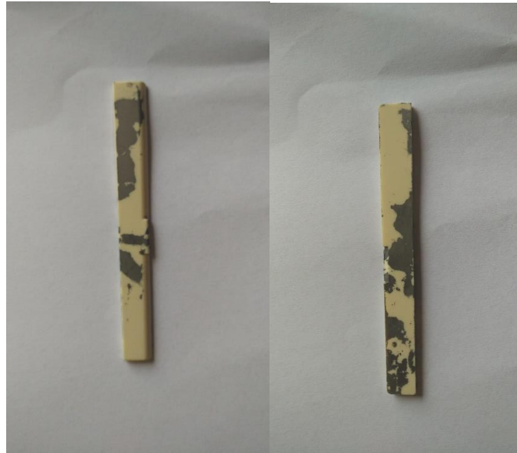
Gambar 4.2 Kegagalan pelapisan nikel yang tidak merata dari spesimen plastik ABS
