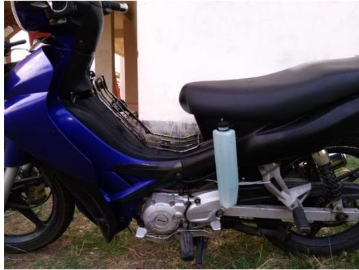
**Gambar 3.32.** Pemasangan tangki mini pada motor
