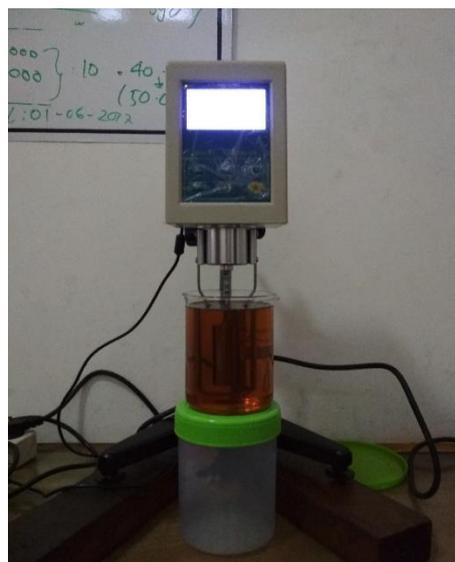
**Gambar 3.23.** Proses pengujian viskositas
