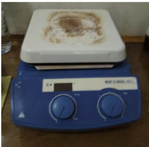
**Gambar 3.22.** *Heater* pemanas minyak pelumas
