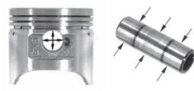
Gambar 4.8 Memeriksa celah pada pin piston (Salda, 2016)
