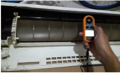
Gambar 7. Skema pengukuran kecepatan udara dengan anemometer
