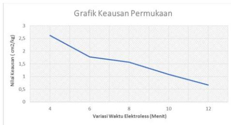
Gambar 9. Grafik Hasil Pengujian Keausan
