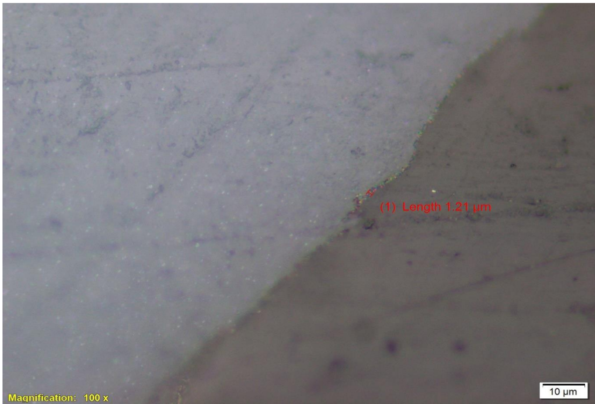
Hasil uji ketebalan mikro spesimen variasi waktu 4 menit sebesar 1,21 μm.
