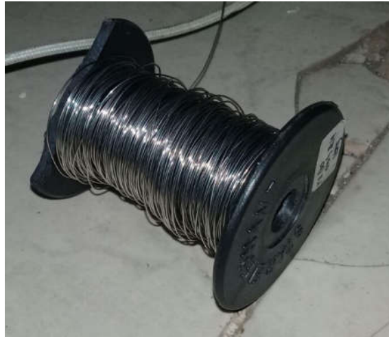
Gambar 2.15 Kawat Nicrome Ni80 AWG 24
