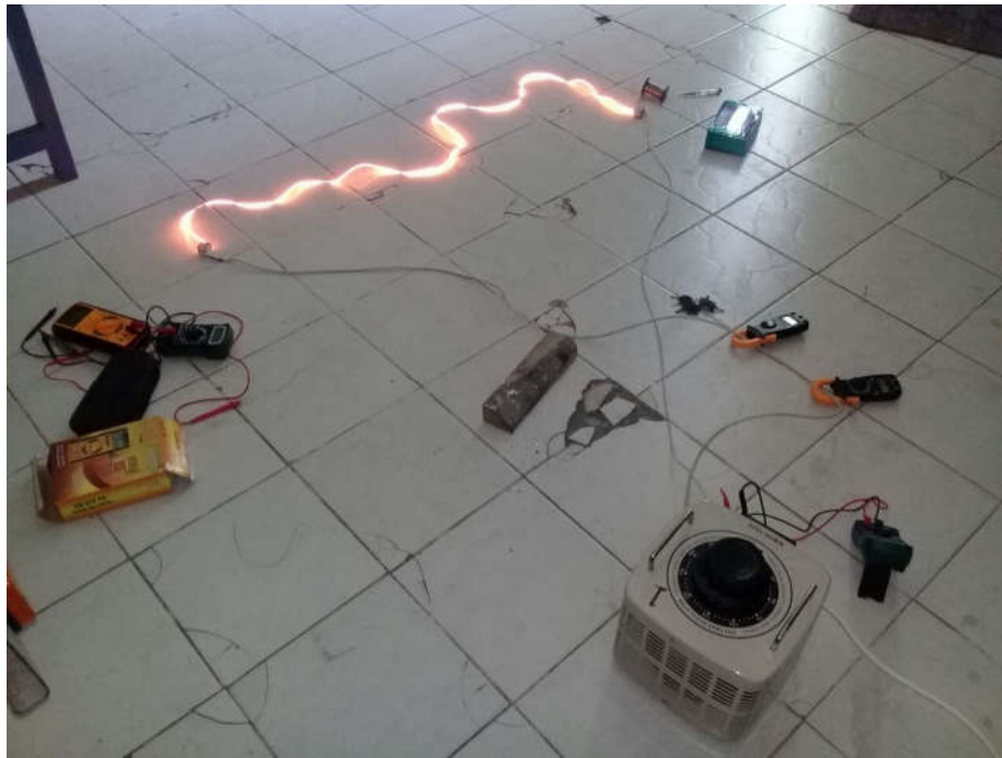
Gambar 4.8 Uji putus dan penentuan kebutuhan panjang kawat pemanas
