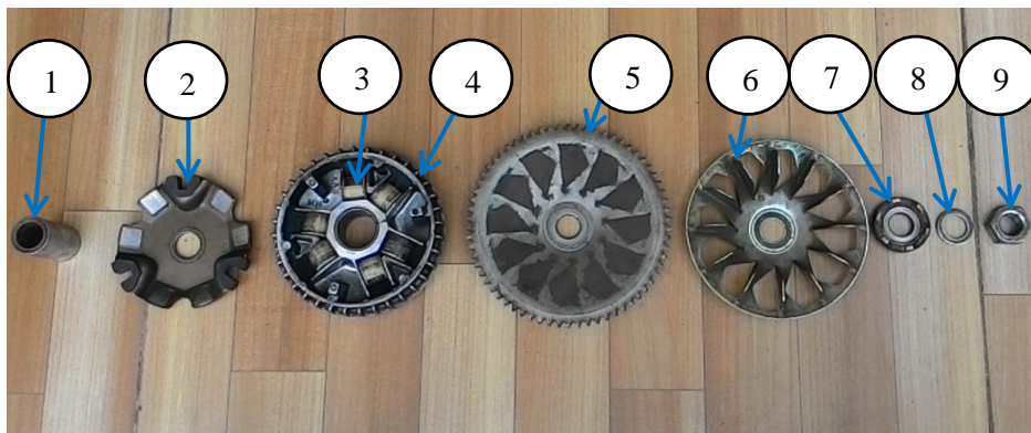
Gambar 3.6 Komponen Pada Puli Primer
