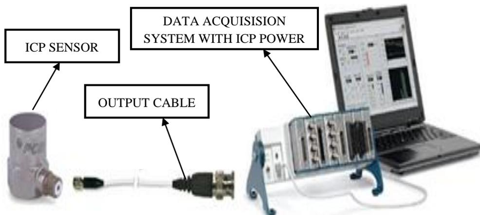
Gambar 2.19 Komponen DAQ System
