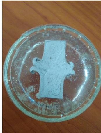
Gambar 4.3 Spesimen pengujian struktur mikro
