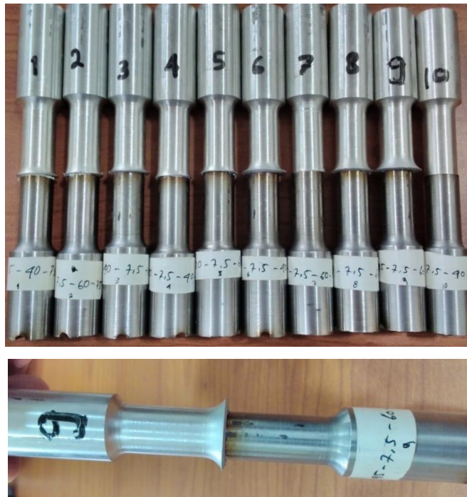
Gambar 4.1. Hasil pengelasan gesek aluminium alloy 2024 T4 dan stainless steel AISI 420
