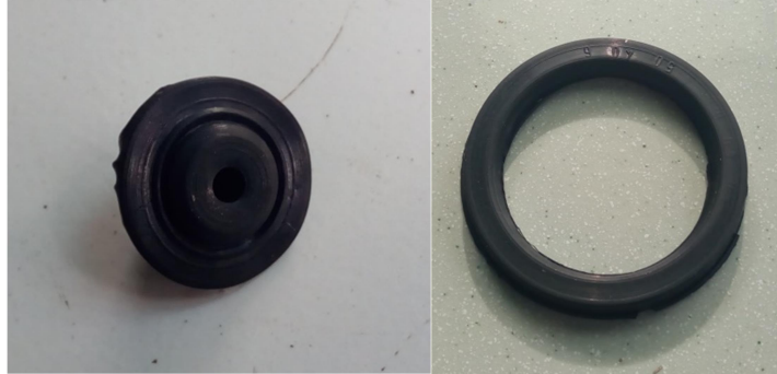
Gambar 5. 1 Produk tutup dongkrak dan O-ring yang telah dicetak
