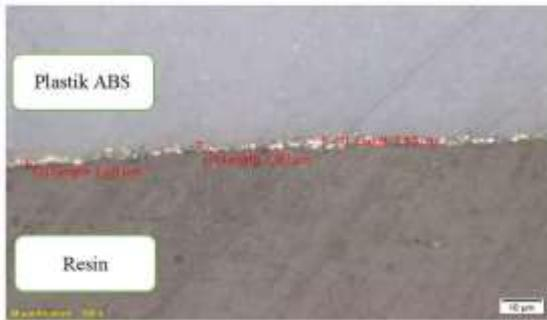
**Gambar 10.** Foto struktur lapisan 10 menit
