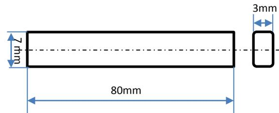
**Gambar 2.** Spesimen plastik ABS
