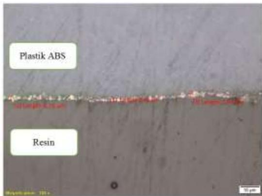
**Gambar 12.** Foto struktur lapisan 12 menit
