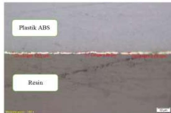
**Gambar 7.** Foto struktur lapisan 4 menit
