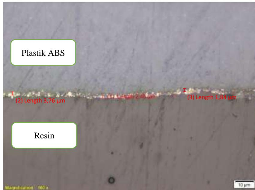
**Gambar 4.9.** Foto struktur lapisan pada spesimen dengan waktu aktivasi katalis palladium 12 menit
