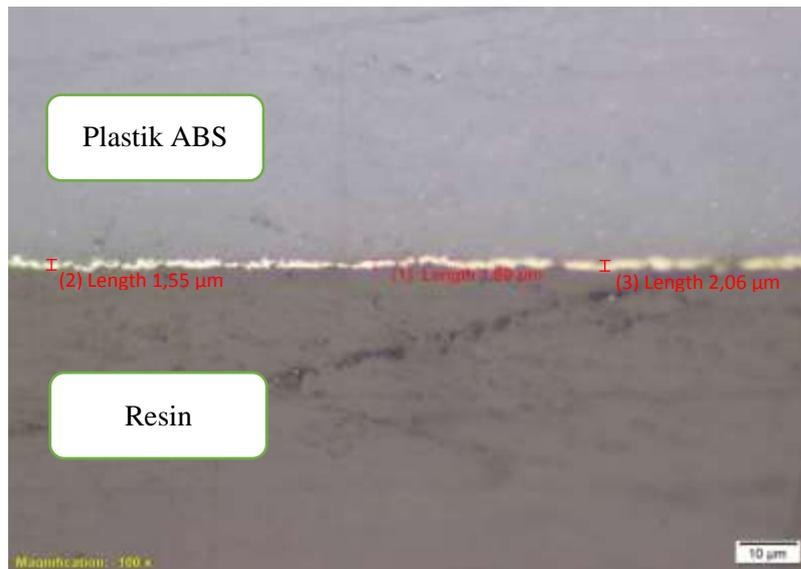
**Gambar 4.5.** Foto struktur lapisan pada spesimen dengan waktu aktivasi katalis palladium 4 menit
