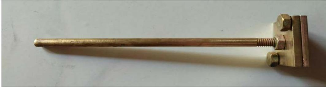
Gambar 2.12. *Tool / elektroda Kuningan*
