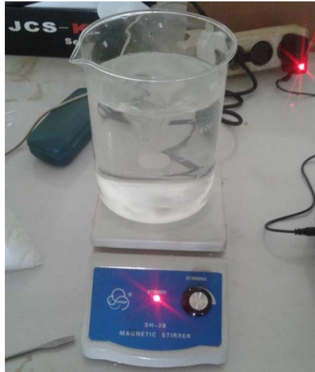
Gambar 3.4. Pencampuran NaCl dan Aquades menggunakan magnetic stirrer
