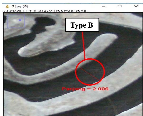
Gambar 13. Hasil overcut terkecil type B pada konsentrasi elektrolit 15% dan tegangan 10 volt
