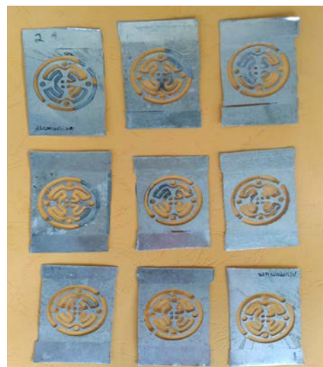
Gambar 8. Hasil pemesinan ECM dengan variasi tegangan 7,10 dan 13 volt dan konsentrasi elektrolit 10%,15% dan 20%.
