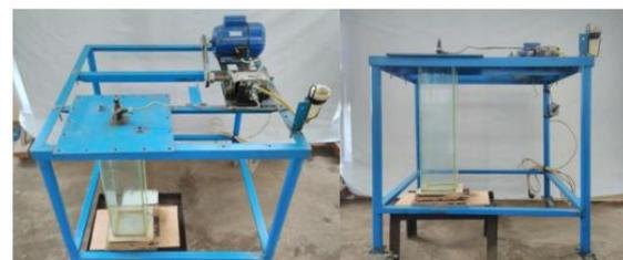
Gambar 5. Alat uji karakteristik injeksi
