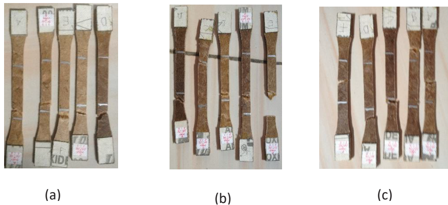
Gambar 4.1 Foto patahan hasil uji tarik PP : LDPE (a) 1 : 1, (b) 2 : 1, (c) 1 : 2
