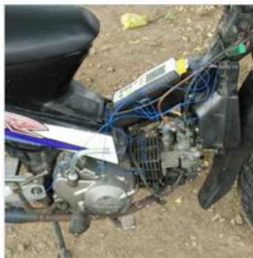
Gambar 3.36. Pengecekan temperatur mesin
