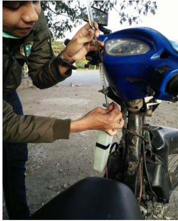
Gambar 3.34. Proses pengisian bbm dengan buret
