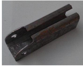
Gambar 4.35 Bentuk Tumpuan Clynder Pneumatik
