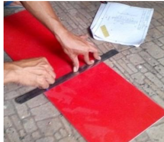
Gambar 4.29 Proses pengukuran untuk menentukan titik pusat lubang
