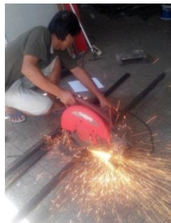
Gambar 4.24 Proses Pemotongan Besi
