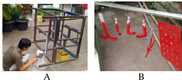
Gambar 4.49 A. Proses pengecatan Kerangka dan B. Proses Pengecatan setiap komponen.
