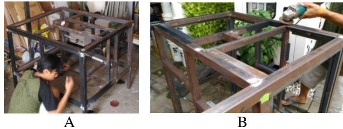
Gambar 4.48 A. Proses pelepasan komponen dan B. Proses Pengamplasan
