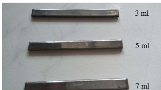
Gambar 2. Hasil pelapisan nikel pada plastik ABS
