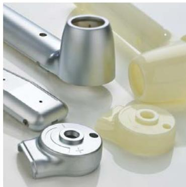
**Gambar 2.2.** Produk hasil pelapisan logam pada plastik ABS(Wahyudi, 2012)
