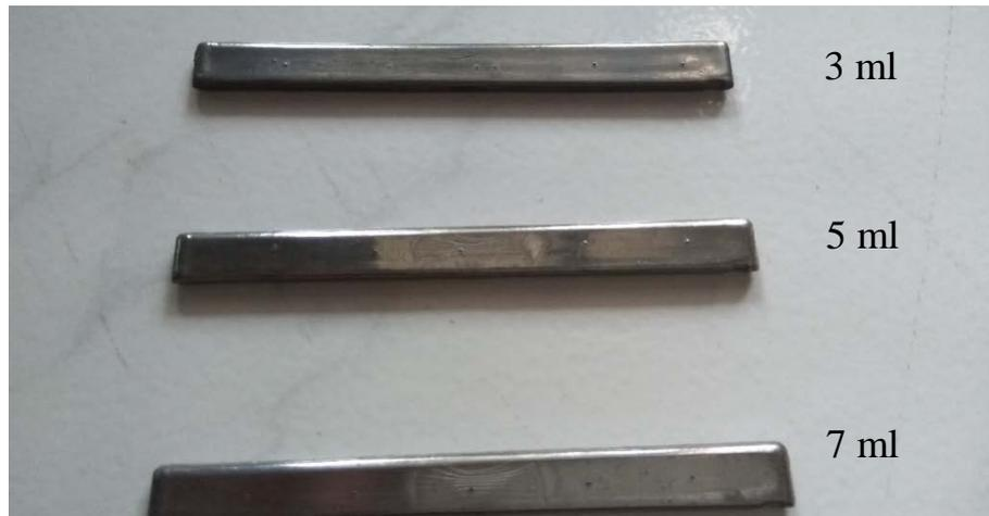
**Gambar 4.1** Hasil pelapisan nikel pada plastik ABS
