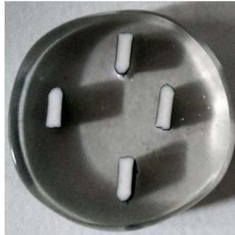
**Gambar 4.6.** Spesimen yang sudah diresin
