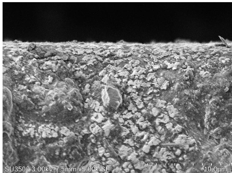
**Gambar 4.11.** Struktur mikro permukaan plastik ABS lapis nikel variasi konsentrasi katalis palladium 3ml.
