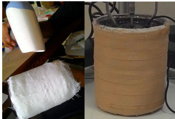
Gambar 3.20. Proses pembuatan dan hasil gelas dengan isolator
