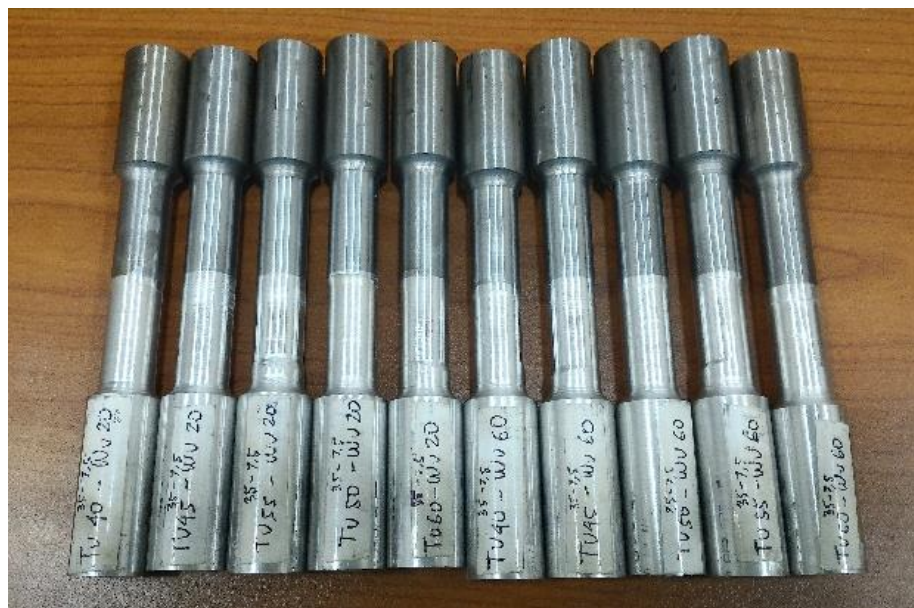
Gambar 4.12. Spesimen Uji Tarik Aluminium Alloy 2024-T4 dan Stainless Steel AISI 420 sesuai standar JIS Z 2201
