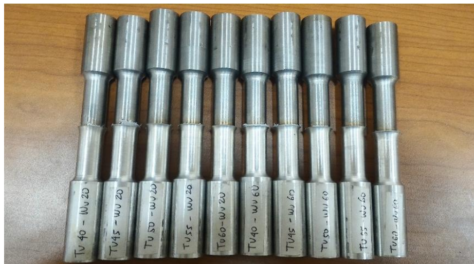
Gambar 4.1. Hasil pengelasan gesek AA2024-T4 dan SS AISI 420
