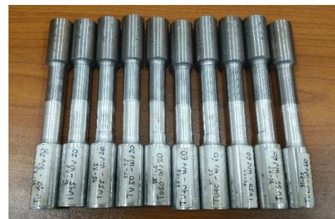
Gambar 4.12. Spesimen Uji Tarik Aluminium 2024 T4 dan Stainless Steel AISI 420 sesuai standar JIS Z 2201
