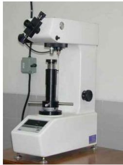
Gambar 3.5. Alat uji metode vickers dan Skematis prinsip indentasi dengan metode vickers
