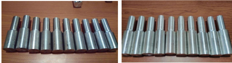
Gambar 3.10. Hasil pemotongan bahan aluminium dan stainless yang sudah dibuat standar JIS Z 2201
