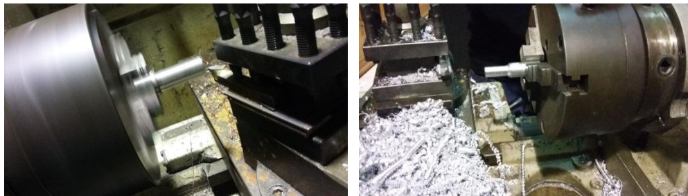
Gambar 3.11. Meratakan ujung bahan aluminium dan stainless steel.
