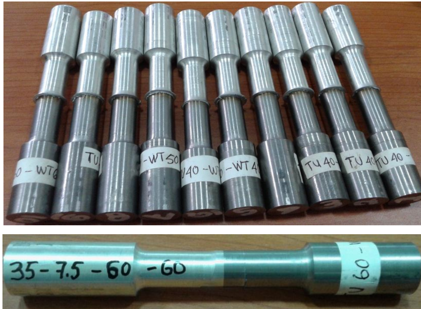
Gambar 4.12. Spesimen Uji Tarik Aluminium 2024 T4 dan stainless steel AISI 420 sesuai standar JIS Z 2201
