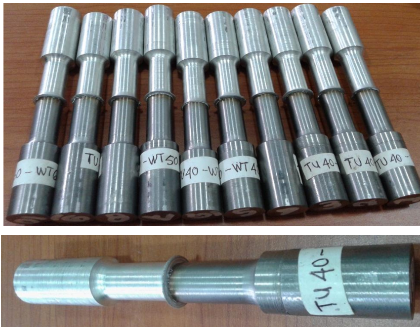
Gambar 4.1. Hasil pengelasan gesek aluminium 2024 T4 dan stainless steel AISI 420.
