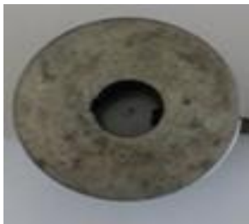
Gambar 3.3. Puli yang digunakan untuk putaran sling pump 40 rpm
