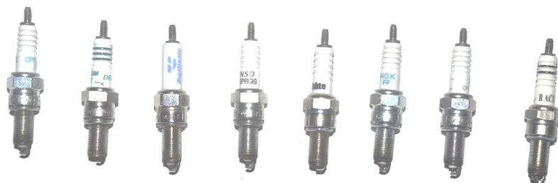
Gambar 3.8. 8 busi untuk motor Honda Kharisma X 125 cc
