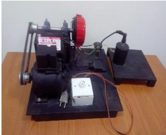
Gambar 3.17. Alat pengujian percikan bunga api pada busi
