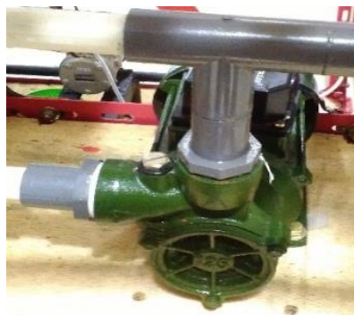
Gambar 3.10 Pompa air jenis sentrifugal
