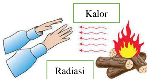
Gambar 2.8 Perpindahan Kalor Radiasi
