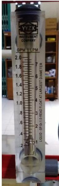
Gambar 3.7 Rotameter Air
