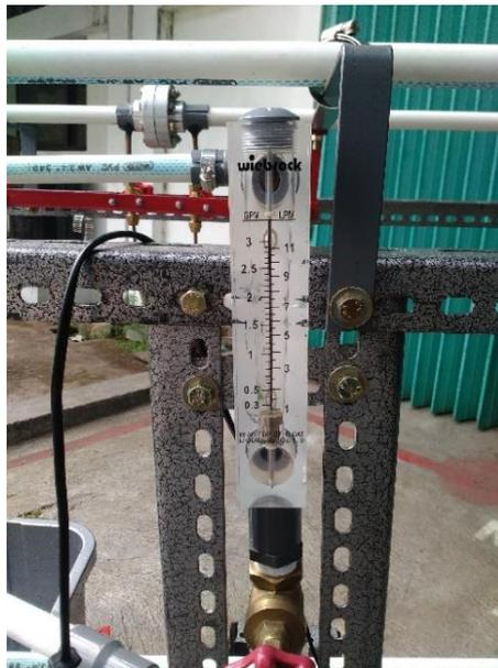
**Gambar 3.5** Rotameter air
