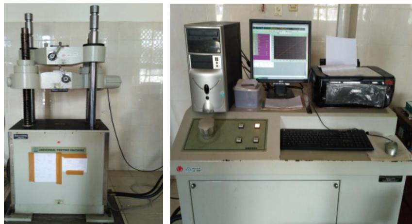
Gambar 3.3 Mesin uji tarik
