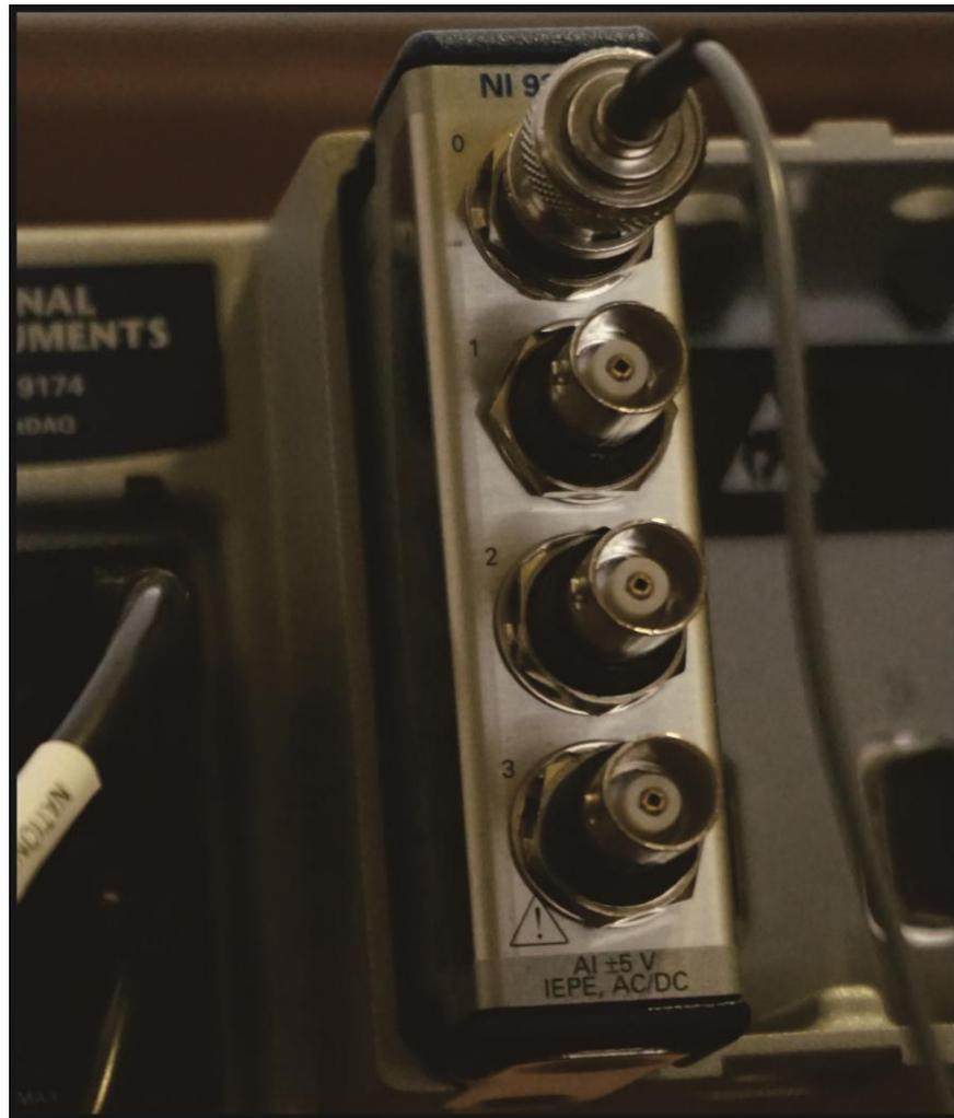
Gambar 3.14 instrumen akuisisi data dan *chassis* penopang
