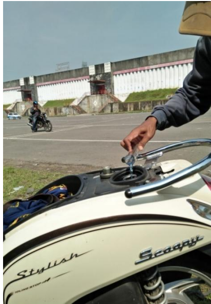
Gambar. Pengujian Koonsumsi Bahan Bakar
