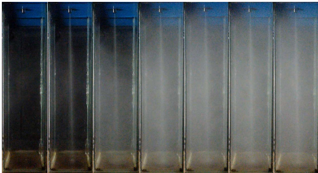
Gambar 4.3. Semprotan Bahan Bakar Biosolar Campuran Aditif
